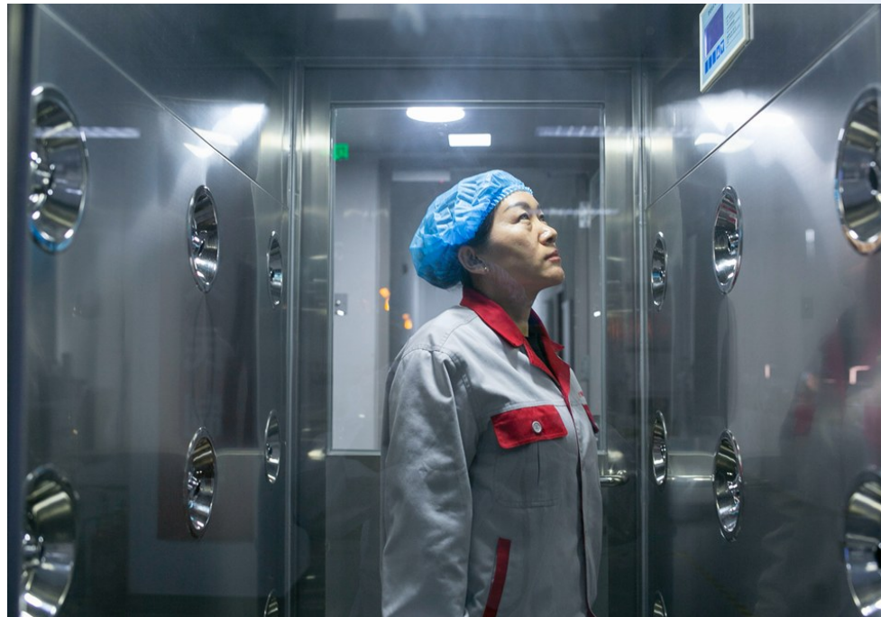
进入制证车间前通过风淋通道。
