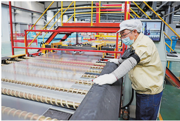
宁夏金晶科技有限公司智慧生产线上,工作人员严把质量关,仔细检查每一块太阳能电池基板(超白玻璃)。“十四五”期间,该公司计划分三期建设太阳能光伏轻质面板项目。
