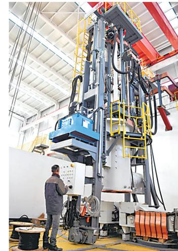
昇力强(宁夏)真空科技股份有限公司年产1000吨高性能合金材料VAR生产项目现场,工人正在进行设备调试。 本报记者 王骁龙 白茹 摄
