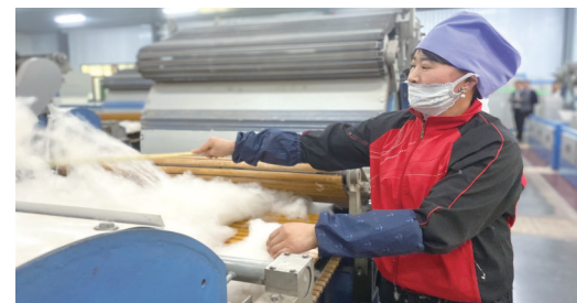
工人正在梳线。
