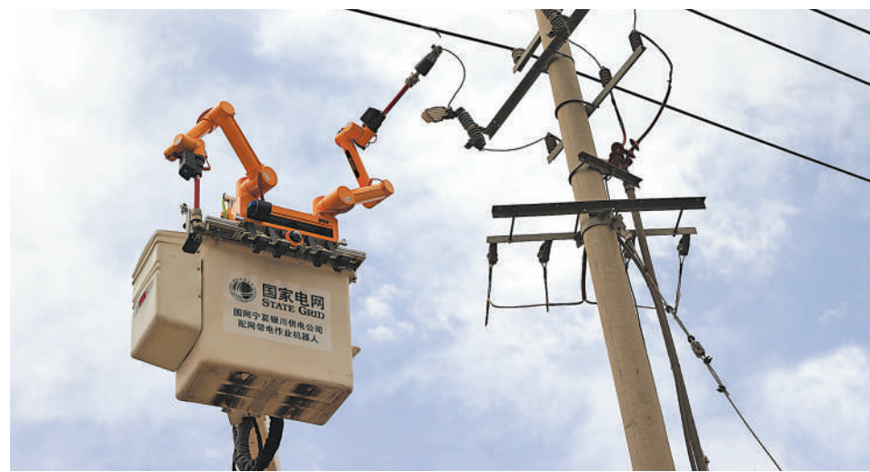
2022年4月8日,国网银川供电公司员工利用带电作业机器人开展用电负荷接入工作。 本报通讯员 田满潮 袁宏彦 摄
