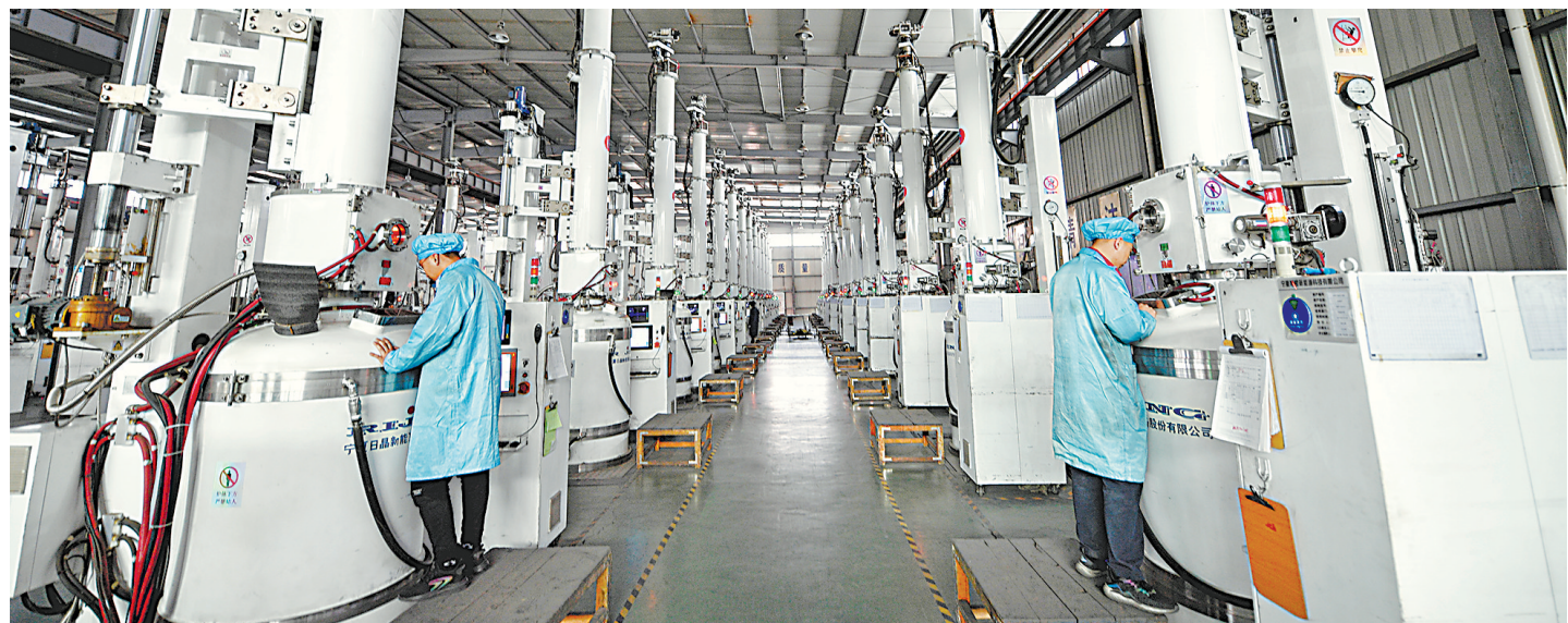
3月8日,宁夏旭耀新能源科技有限公司,工作人员正在查看单晶硅炉运行情况。该公司三期年产5000吨单晶硅棒项目正在进行设备安装,预计今年7月投产。依托金晶科技、旭耀新能源、江苏润阳、宁夏晶体新能源等重点企业,石嘴山市大力发展光伏各环节产品生产能力。力争到2025年,实现多晶硅产能25万吨/年,单晶硅产能50GW/年,硅片产能50GW/年,电池片产能20GW/年,光伏组件产能30GW/年。本报记者 王晓龙 白茹 实习生 郑朝辉 摄
