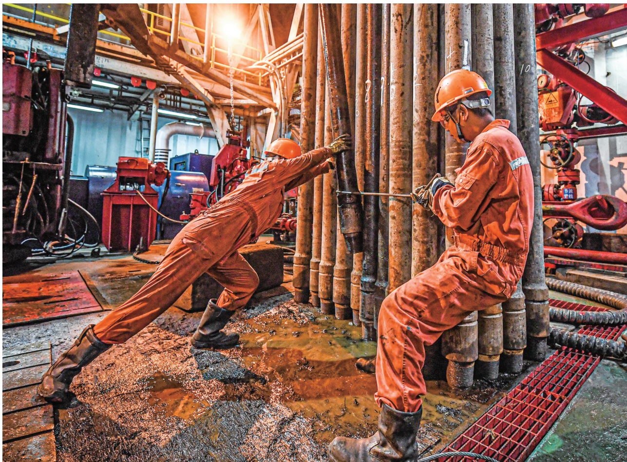
在位于南海北部海域的勘探三号钻井平台上,钻井工人在摆放钻杆(2020年7月26日报)。
