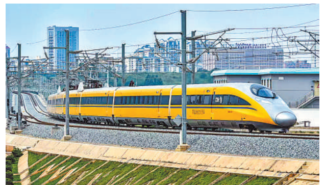
5月16日,高速综合检测列车驶出南宁东站。当日,CRH380AJ-0203高速综合检测列车对贵南高铁全线进行逐级提速试验,以时速180公里的速度级,对南宁东至荔波站区间高铁沿线的轨道、信号、通信、电务、综合接地等多个项目进行检测。列车因车身涂装成醒目的黄色,又被称为“黄医生”。 新华社发
