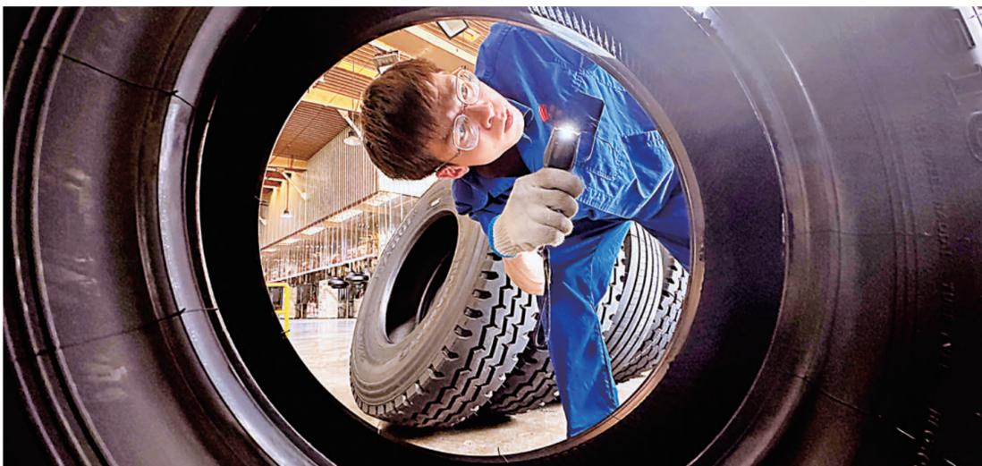
5月25日,在宁夏神州轮胎有限公司生产车间,一位工人利用手电筒检查刚刚下线的轮胎内部。
