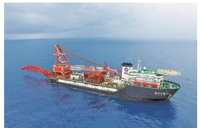
这是亚洲首艘3000米级深水铺管起重船“海洋石油201”(6月22日报)。6月22日,在海南陵水海域,“深海一号”大气田二期工程的关键控制性工程——直径20英寸、总长度约115千米的海底油气长输管道铺设完工,标志着我国深水长输海底管道建设能力和深水装备技术实现重要突破。新华社发
