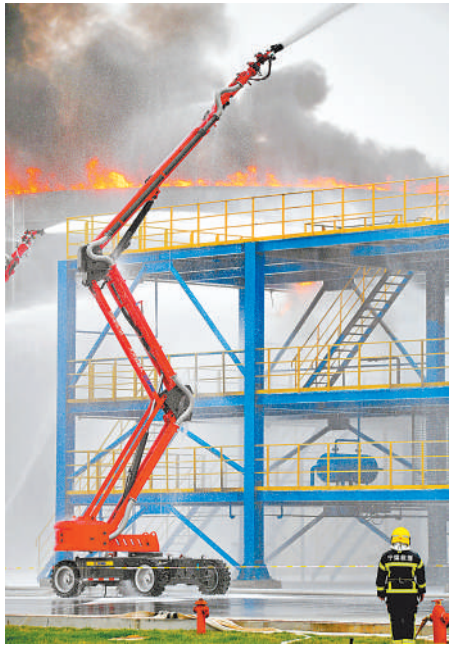
应急救援人员利用无线电动遥控移动灭火炮进行冷却灭火。
