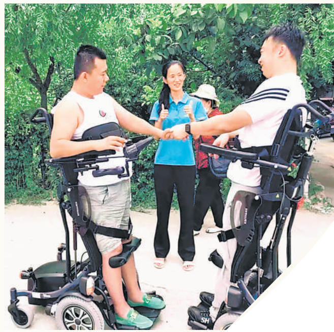
电动站立式轮椅让重度肢体残疾人重新体验站立的感觉。
