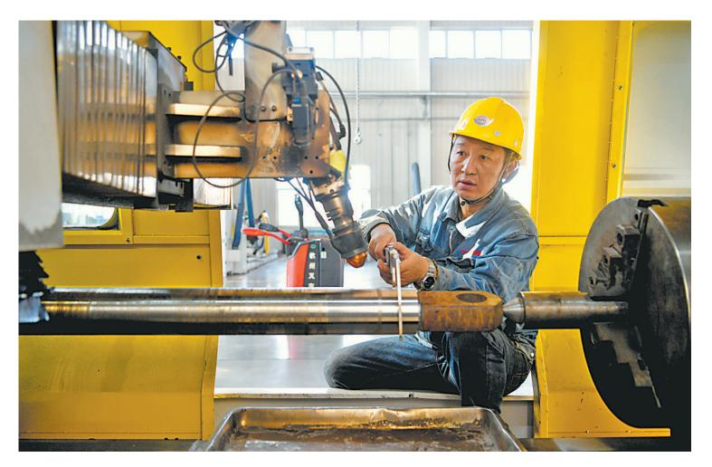
11月6日,宁夏苏宁新能源设 备有限公司煤机装备再制造车间, 工作人员在激光熔覆设备上测量 产品尺寸。该公司装备再制造项 目主要是液压支架的大修再制造。 2023年已完成销售4120万元。 近年来,石嘴山市大武口区
