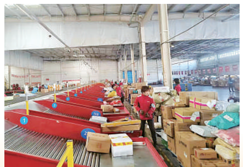
京东快递银川分拣中心新安装的智能化窄带设备。
