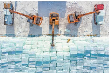
1月19日,工人操控机械在哈尔滨冰雪大世界存冰场码放冰球(无人机照片)。哈尔滨冰雪大世界每年都会在采冰季挑选出一批冰球储存,采用传统储冰方式与现代多层保温技术相结合的方式,让冰球储存近一年时间不融化,供一届冰雪大世界建设时使用。新华社发
