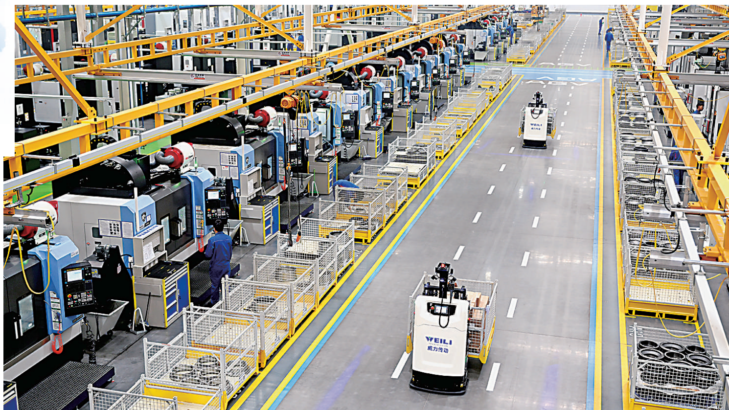
银川威力传动技术股份有限公司精密减速器研发生产项目车间,智能化机器人进行搬运作业。该公司自主研发的行星齿轮减速器装配流水线为行业最快。 本报记者 王鼎 摄
