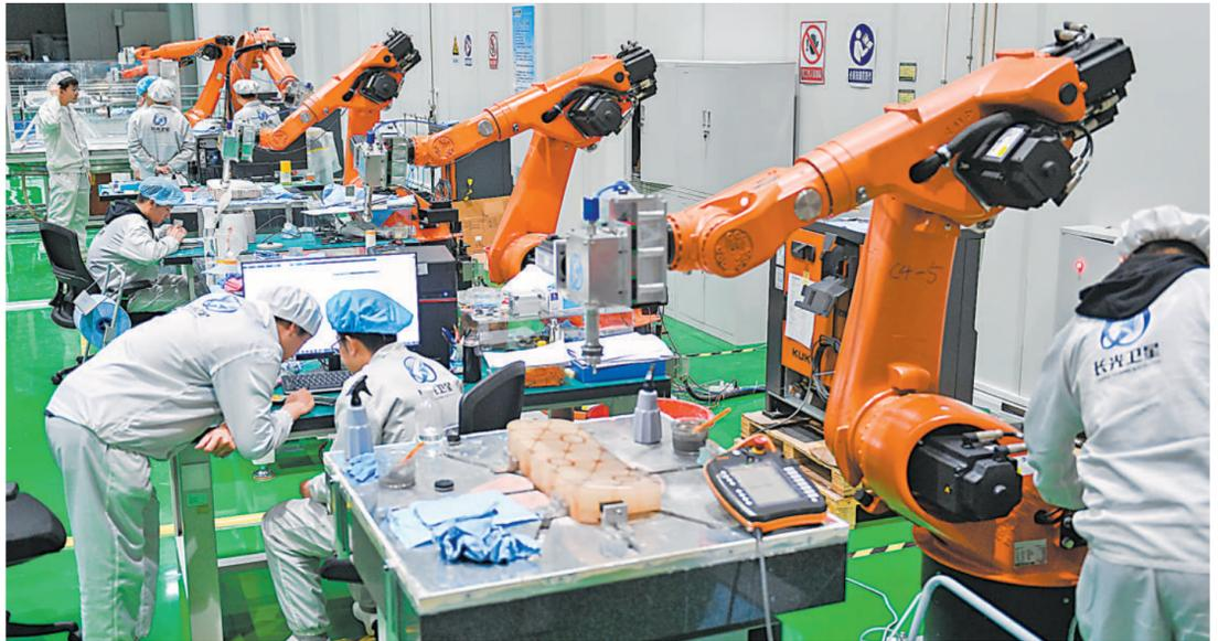
科研人员利用智能机器人研抛平台加工光学反射镜(4月3日摄)。如果把光学遥感卫星比作太空中的“千里眼”,那么其中的光学反射镜就是“角膜”。在位于吉林长春的长光卫星技术股份有限公司,便有一群为“千里眼”配“角膜”的光学加工科研人员。光学元件的质量和精度是决定光学遥感卫星功能指标的重要因素之一。卫星在太空运行过程中,光学元件上的“毫厘之差”往往会导致实际应用中的“千里之失”。据科研人员介绍,为保障其精度和稳定性,光学元件需经过研磨、抛光、精修、镀膜等一系列精细加工工序,并在加工过程中反复进行各项测试,确保其质量和成品率,让卫星能够将世界风光“尽收眼底”。
