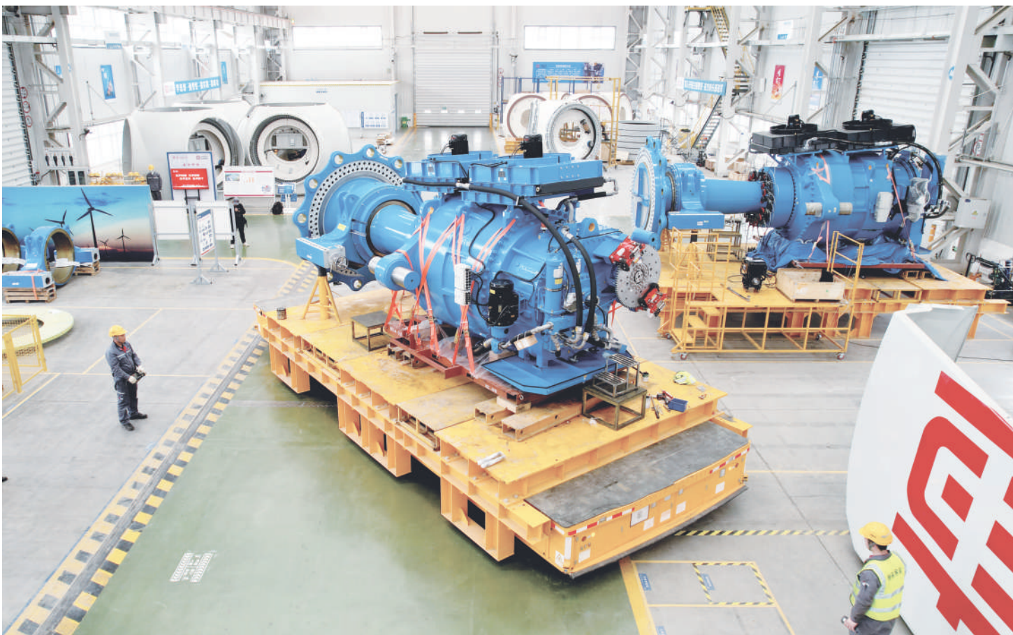
海原县海兴开发区,宁夏中车新能源有限公司风电整机装备制造项目现场,工人操作天车将主传动链置入机舱罩。该项目具备年产500台套风电机组总装生产能力。 本报记者 王晓龙 白茹 摄
