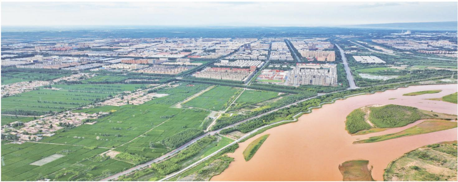
6月30日,航拍的吴忠市古城湾人工湿地。作为吴忠市第一污水处理厂尾水水质提升工程的古城湾人工湿地占地面积240亩,核心是187亩潜流湿地。采用“生态滞留塘+潜流湿地+表面流湿地”组合工艺,对入黄水进行深层洁净。污水日处理能力为6万立方米,年可削减污染物520吨。据了解,黄河干流吴忠过境水质连续8年实现Ⅱ类进出。去年,吴忠市实施湿地生态修复治理项目6个,投入湿地生态修复资金3300余万元,保护修复湿地10.29万亩,任务完成率达110%。
