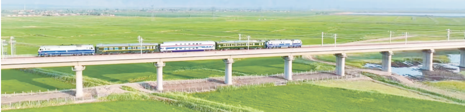
检测列车进行轨道、接触网状态的检测。
