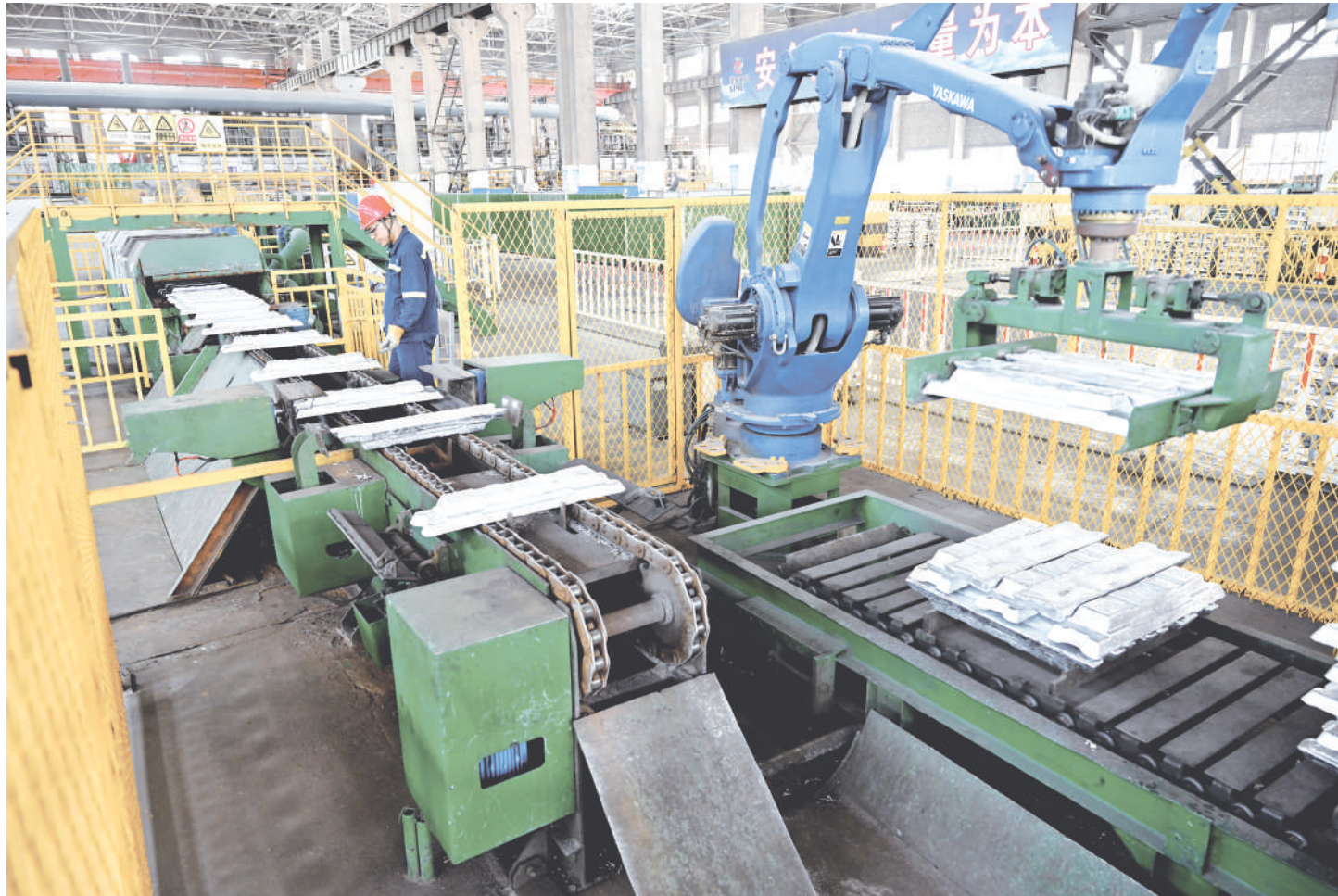
7月16日,国家电投集团铝业投资有限公司青铜峡分公司生产车间内,码垛机器人正在作业。随着该公司5G智慧工厂的建成,不仅提高了生产效率,也为其安全生产和高质量发展奠定了坚实基础。本报记者 王鼎 马赛尔 摄
