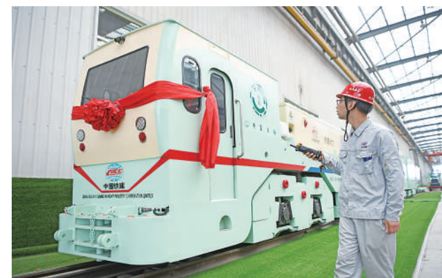
8月3日,中铁长安重工有限公司技术人员通过遥控设备对无人驾驶电机车进行操作。 当日,由中铁长安重工有限公司自主研制的无人驾驶电机车在西安市阎良区正式下线。据了解,该设备主要应用于隧道施工现场,搭载高清摄像头、激光雷达等装置,具备自动避障、自适应巡航、故障自诊断等功能,定位精度可达厘米级。工作人员可远程监测车辆在隧道内的实时位置、运行画面、轨道情况等关键信息,实现电机车“装、运、卸”全流程可视化和无人化。 新华社发
