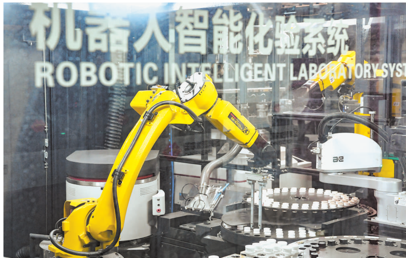
8月14日,国家能源集团宁夏电力宁东电厂智能煤检中心智能化验室内,工业机器人正在抓取煤炭样本送入检测设备。宁东电厂燃料全过程智能化管控系统近日上线运行,标志着我区首家燃料全过程智能化管控电站的诞生。本报记者 王晓龙 摄
