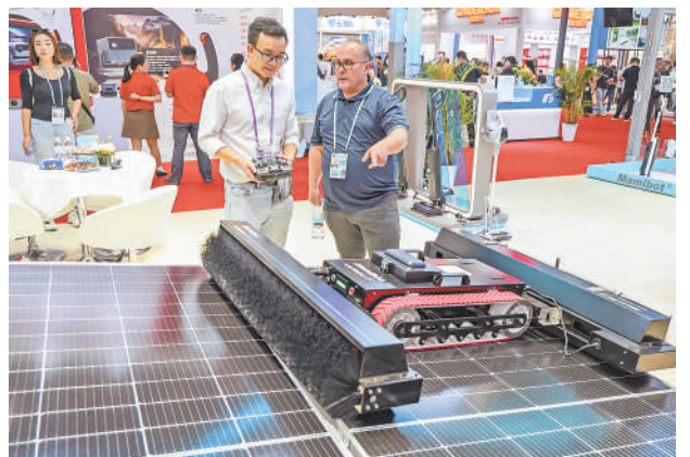
10月15日,采购商在第136届广交会展馆了解一款太阳能面板自动清洁机器人产品。第136届广交会聚焦“先进制造”“品质家居”“美好生活”题材,众多绿色低碳产品在线下展出。新华社发
