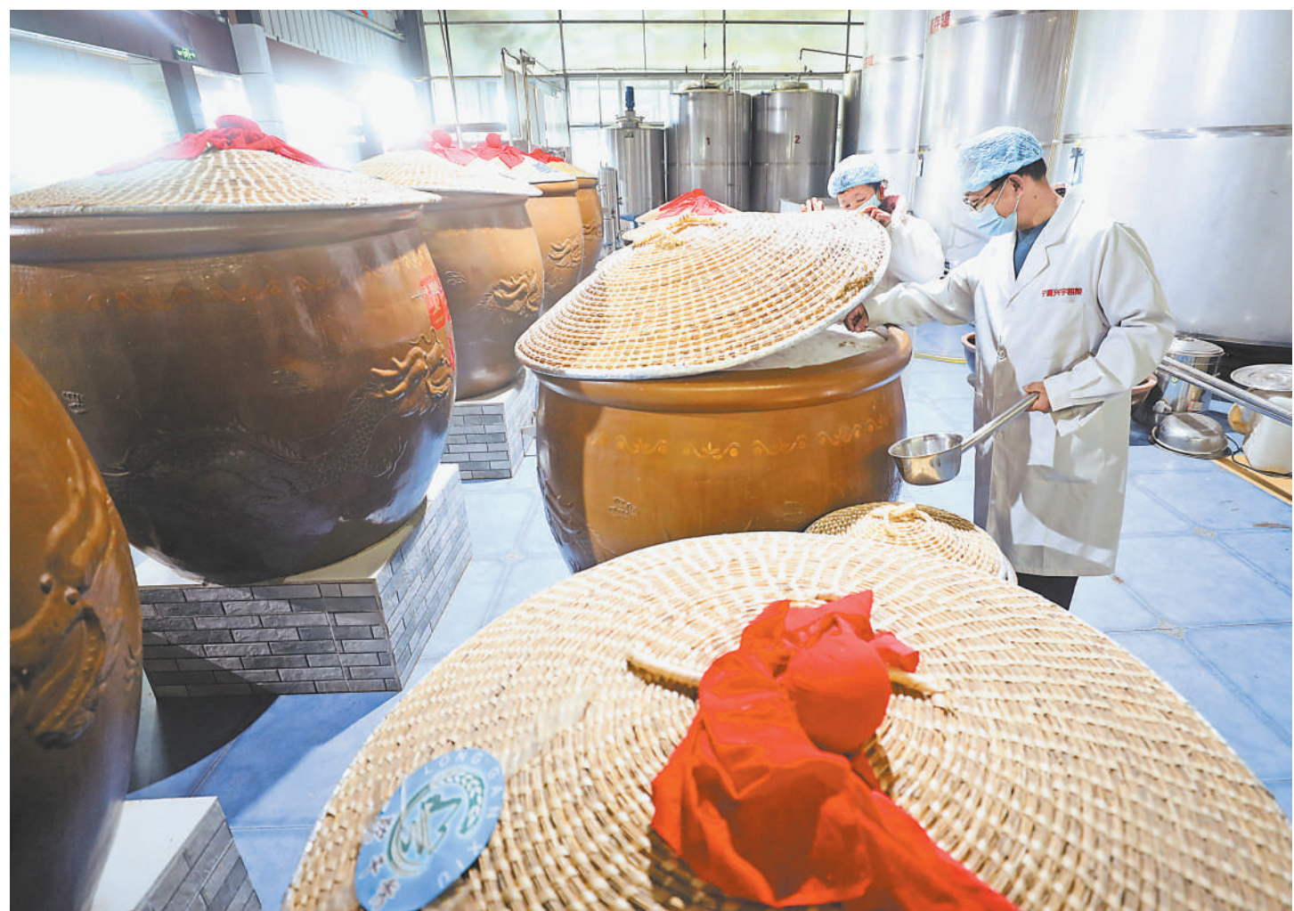
12月5日,在隆德县六盘山工业园区宁夏兴宇绿色粗粮加工有限公司,工人巡检发酵池,确保温度维持在30摄氏度左右,以酿制出优质香醋。该企业用小麦、高粱、豌豆和玉米等作原料,采用石磨低温脱皮等传统工艺年产香醋1300吨。作为国家科技型中小企业及非物质文化遗产传承基地,生产的“既干秀”牌陈醋在第31届中国杨凌农业高新科技成果博览会上获“后稷奖”。
