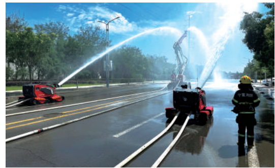
举高喷射灭火机器人和全地形灭火机器人梯次掩护训练。
