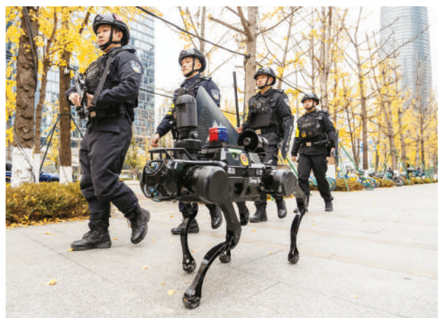
12月13日,成都市公安局高新分局巡逻大队警员和机器狗在街面巡逻。这批警用机器狗,单体重约50KG,行动灵活,最快速度4米/秒。可实现奔跑、跳跃、自主避障、自动导航及自动充电等功能。该机器狗搭载了自主研发的机器人脑,高度智能化,能够自主完成既定任务。新华社发
