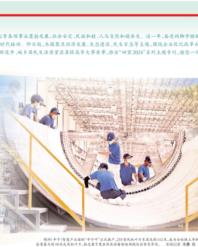
明阳(中宁)智慧产业园的“中宁号”正式投产,233型风机叶片长度达到112米,成为全球陆上单机容量最大的10兆瓦风机叶片,标志着宁夏在风电设备制造领域迈出坚实步伐。本报记者 王鼎 摄
