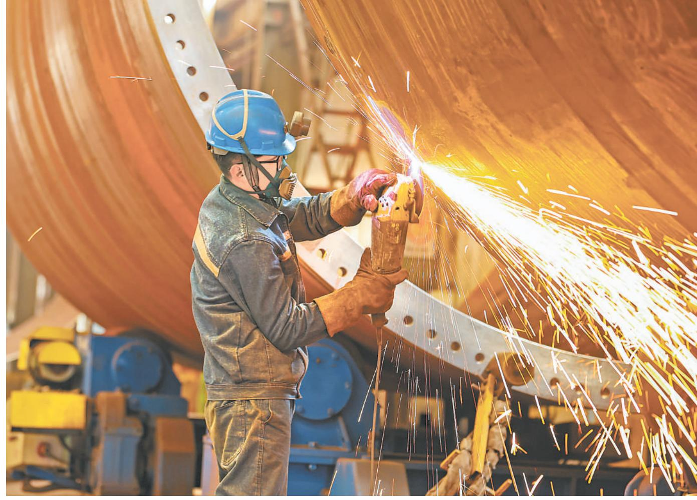
2月5日,江苏省连云港经济技术开发区一家风力设备公司工人在车间内生产风电塔架。
