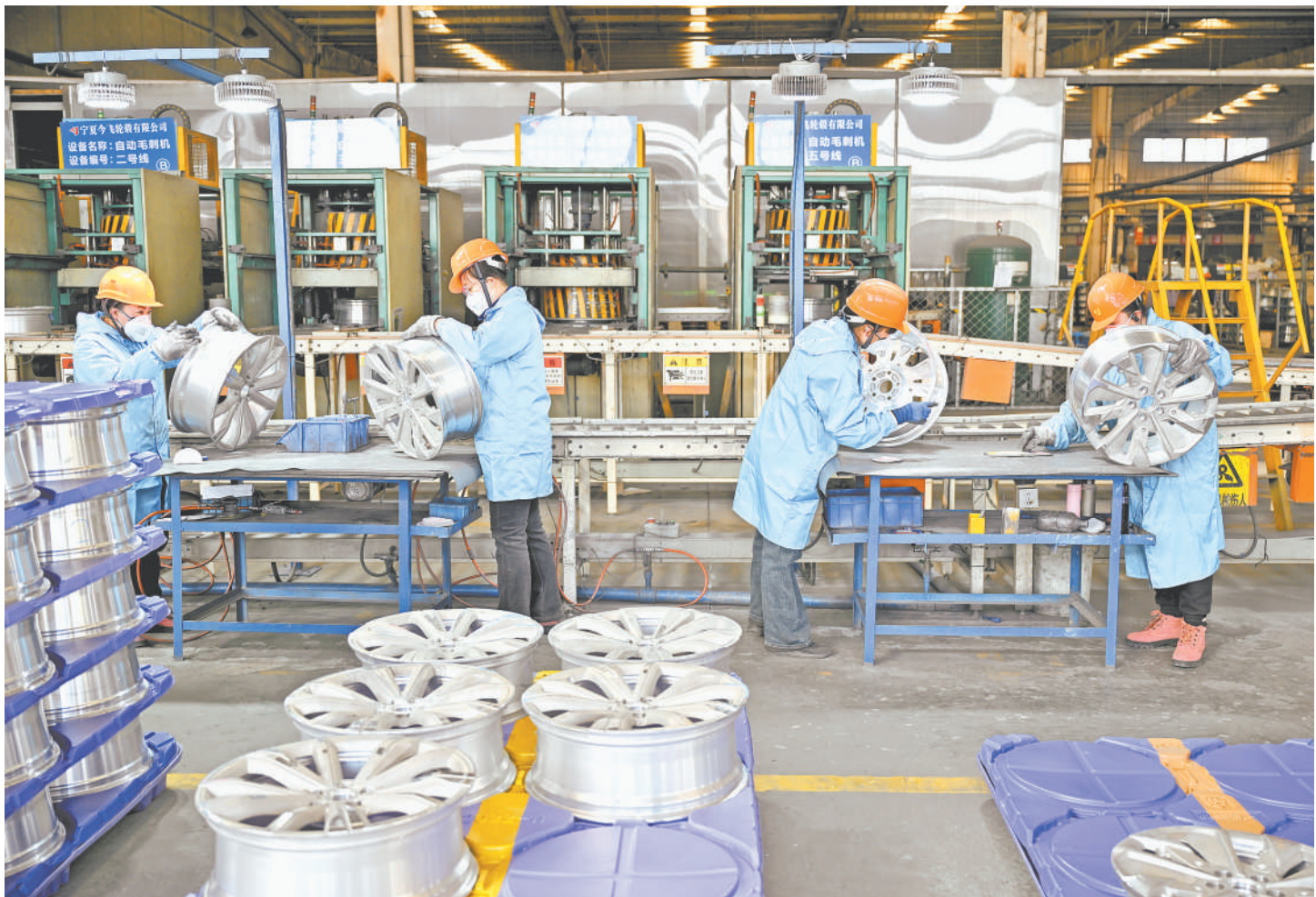
2月13日,在宁夏今飞轮毂有限公司车间,质检人员对铝合金轮毂半成品进行精密检测。今年,该公司将启动智能化升级项目,拟投资4.02亿元建设年产120万件铝合金轮毂的未来工厂,达产后预计新增产值5.5亿元,创造就业岗位300个。
