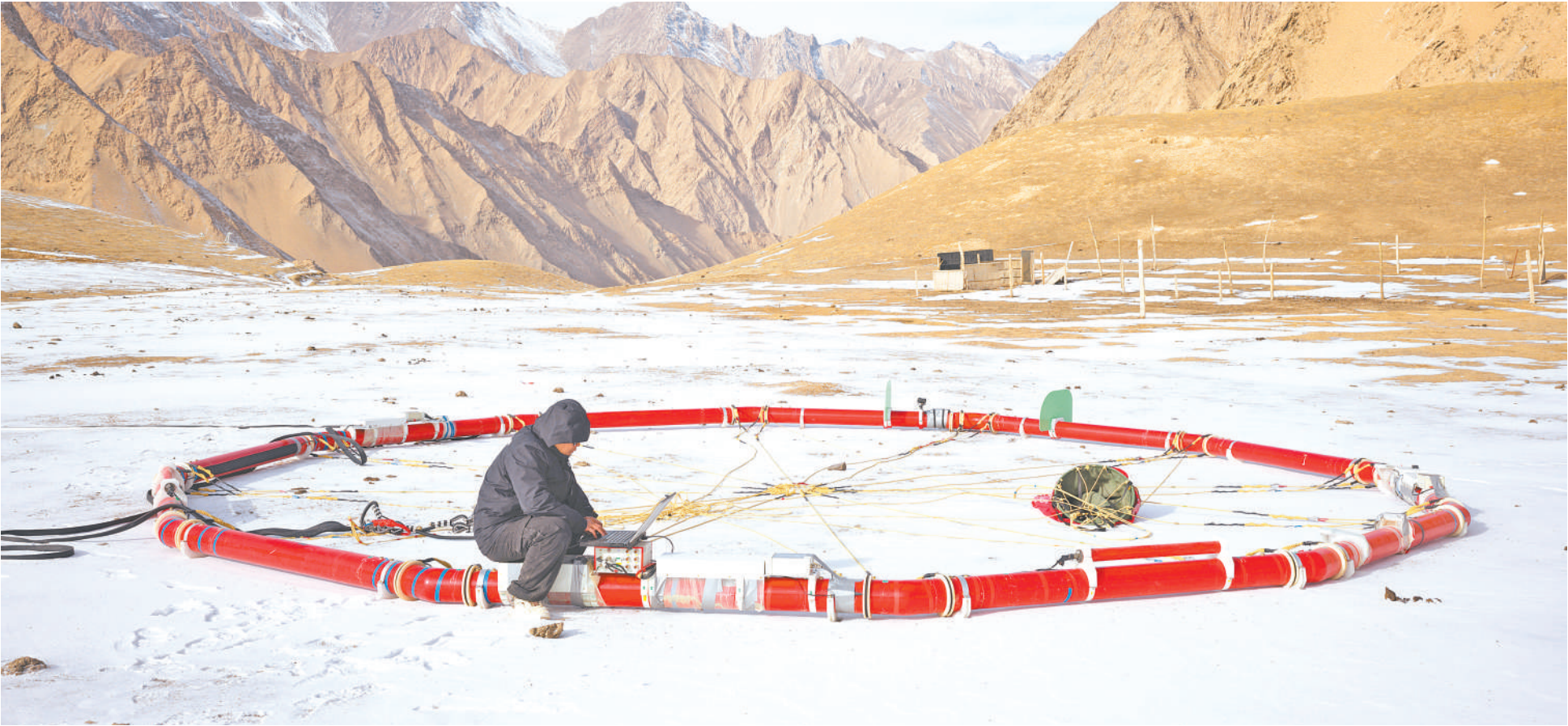
2025年1月11日,科研人员在新疆和田地区测试航空大地电磁探测系统。近日,由中国科学院空天信息创新研究院(空天院)研制的直升机航空大地电磁探测系统,成功应用于高原铁路建设工程,完成5000米高寒高海拔、复杂地形地貌地区的地质勘查任务。该套系统为我国首套直升机航空大地电磁探测系统,具有完全自主知识产权,技术指标达到国际先进水平。 新华社发
