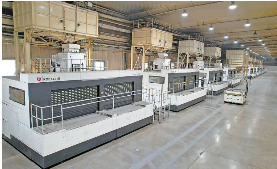
共享集团全球首座万吨级铸造3D打印智能工厂,大型3D打印机不停打印着来自世界各地的订单产品。
