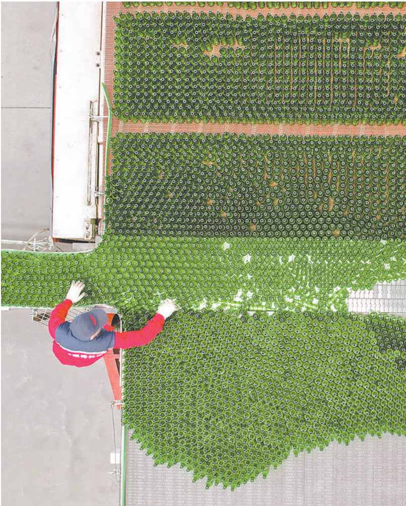
宁夏金莱特新材料科技有限公司生产车间里,一排排新鲜“出炉”的玻璃瓶经过退温,通过传送带进入质检环节。
