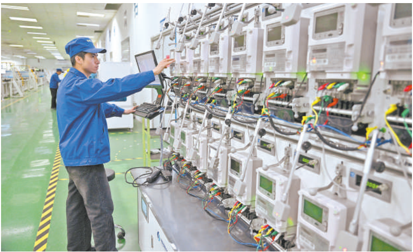
技术人员在宁夏隆基宁光仪表股份有限公司对仪表设备进行校准质检。
