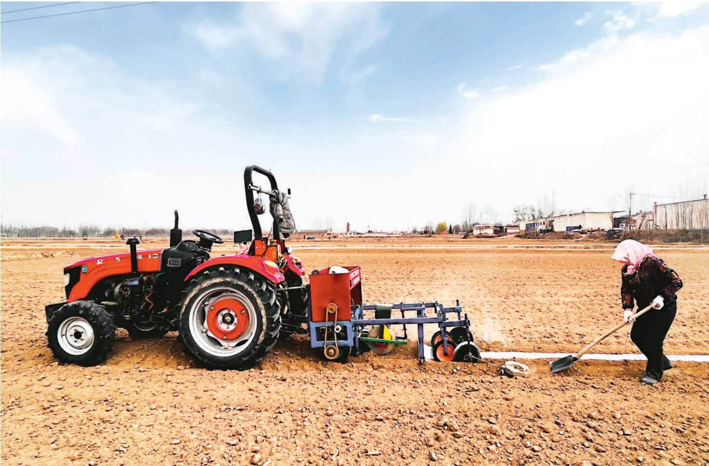
4月10日，青铜峡市小坝镇永丰村制种玉米基地，宁夏福裕农业科技有限公司配备北斗导航智能终端的无人驾驶拖拉机拖着制种玉米播种机，自动穿梭于田间精量播种、覆膜，每天播种面积达150亩。 宁夏日报报业集团全媒体见习记者 李霞霞 摄
