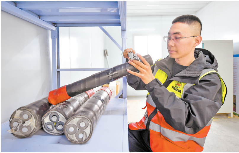
李朋立在项目部试验室检验电缆原材料。
