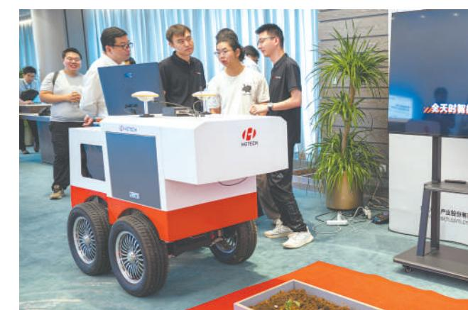
6月28日，参观者在活动现场了解全天候智能激光除草机器人。当日，国内首台全天候智能激光除草机器人在华工科技股份有限公司第三届创新日活动上发布。据介绍，该款机器人内置上千种农作物和杂草的数据模型，可通过AI视觉实时引导激光动态精准控制除草，能根据不同作物调整激光功率，杂草清除率稳定在95%以上。新华社发
