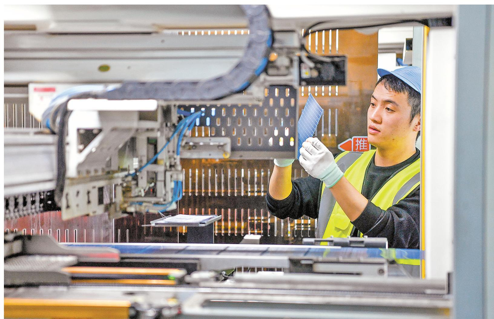
盐池县贺泰新能源科技有限公司组件车间，一块块电池片经焊接、层压、测试等多道工序“聚”成一整块光伏组件。
