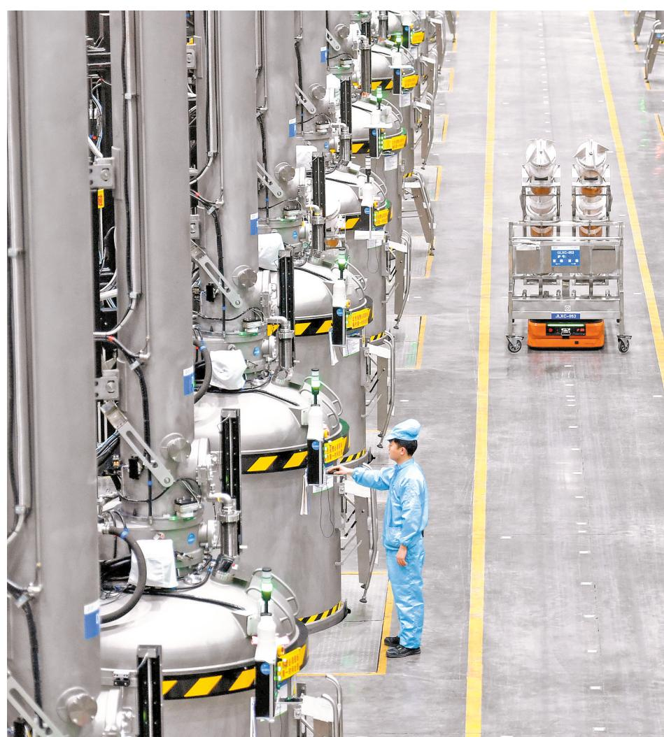
宁夏协鑫光伏科技有限公司，单晶炉提拉头日夜旋转，将原料颗粒硅“吞”进炉中。
