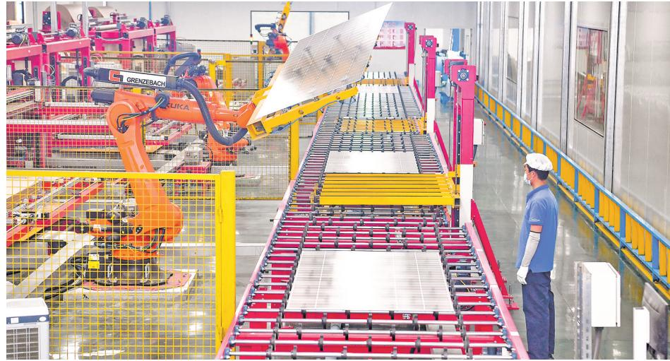
位于石嘴山市大武口区的宁夏金晶科技有限公司，光伏面板玻璃生产车间内，机械臂灵巧运转，一片片光伏玻璃有序下线。
