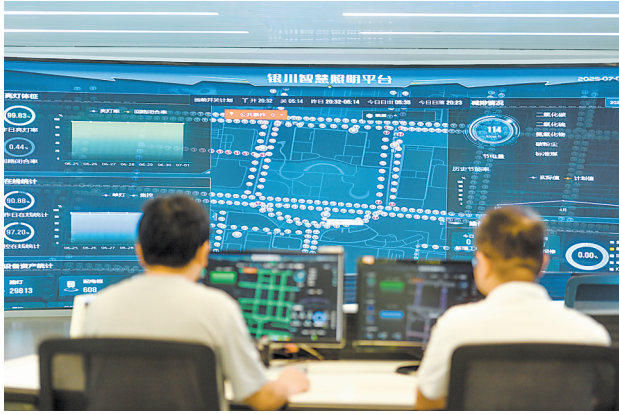
银川市城市道路照明智慧管理平台可根据时间、地点、应用场合控制光源功率,实现按需照明、分区照明。
