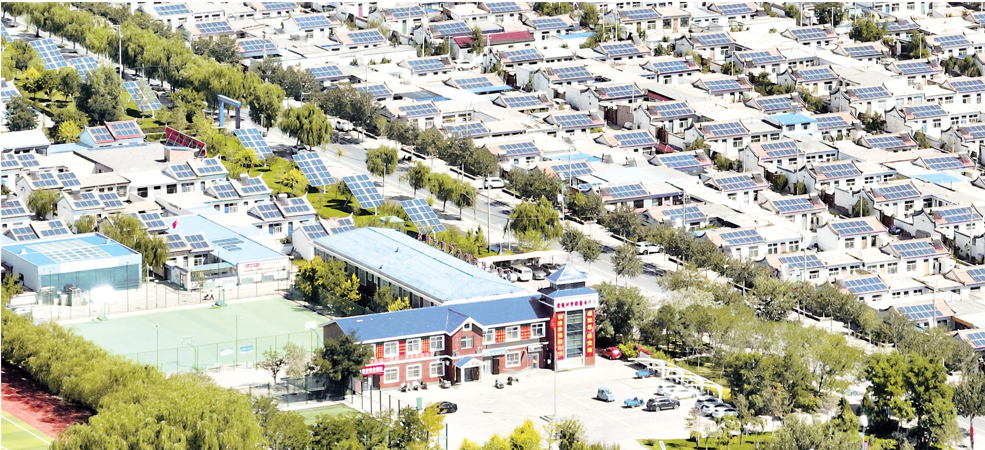
永宁县闽宁镇原隆村(9月1日摄)。原隆村依托1635户移民的屋顶，建设了5兆瓦屋顶光伏电站，采用“支部+合作社+农户”模式，大力发展板上发电、板下养殖及种植的“光伏+农业”项目，实现了生态效益和经济效益双丰收。 本报通讯员 袁宏彦 摄
