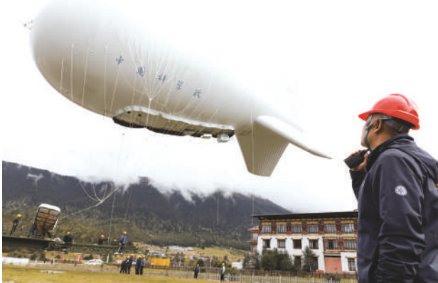
9月18日,“极目一号”浮空艇在升空。近日,第二次青藏高原综合科学考察研究(第二次青藏科考)在西藏林芝市巴宜区鲁朗镇成功开展“极目一号”浮空艇大气观测试验。该浮空艇搭载3大类共16型、总重量约200公斤的科学载荷,成功升空至海拔5500米高度,通过多载荷协同观测,实现从单点采样到立体监测的技术跨越。新华社发
