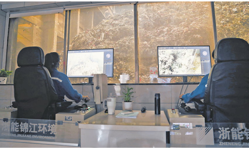
工作人员通过机械抓手将生活垃圾送入焚烧炉进行焚烧。
