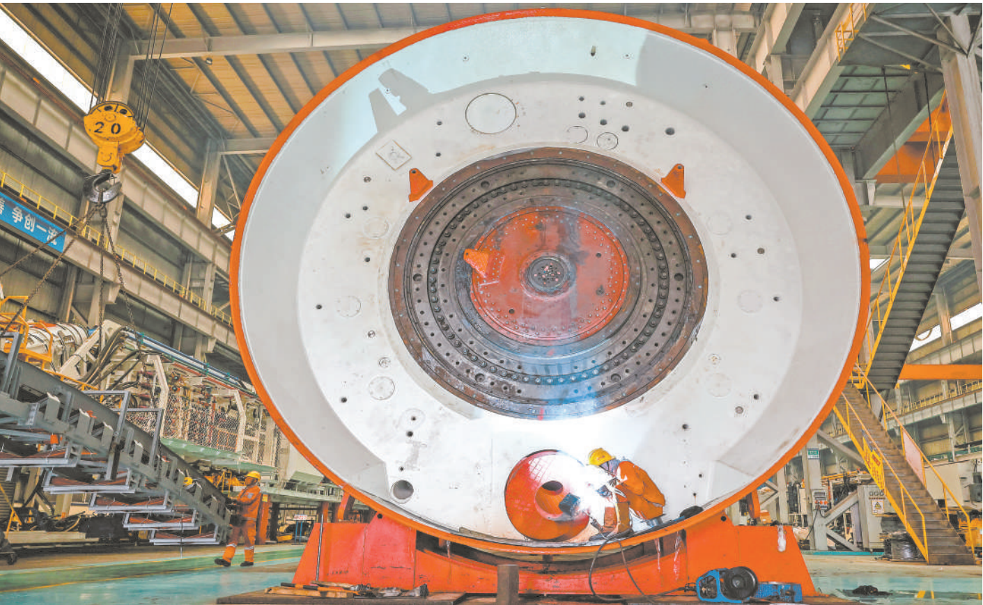
10月27日，中铁科工集团轨道交通装备有限公司技术工人对盾构机盾体进行电焊作业。 新华社发
