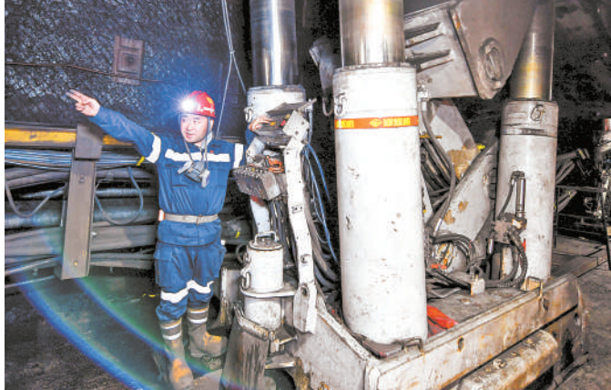
枣泉煤矿综采二队生产一班班长杨耀恒正在操作单元式超前支架。
