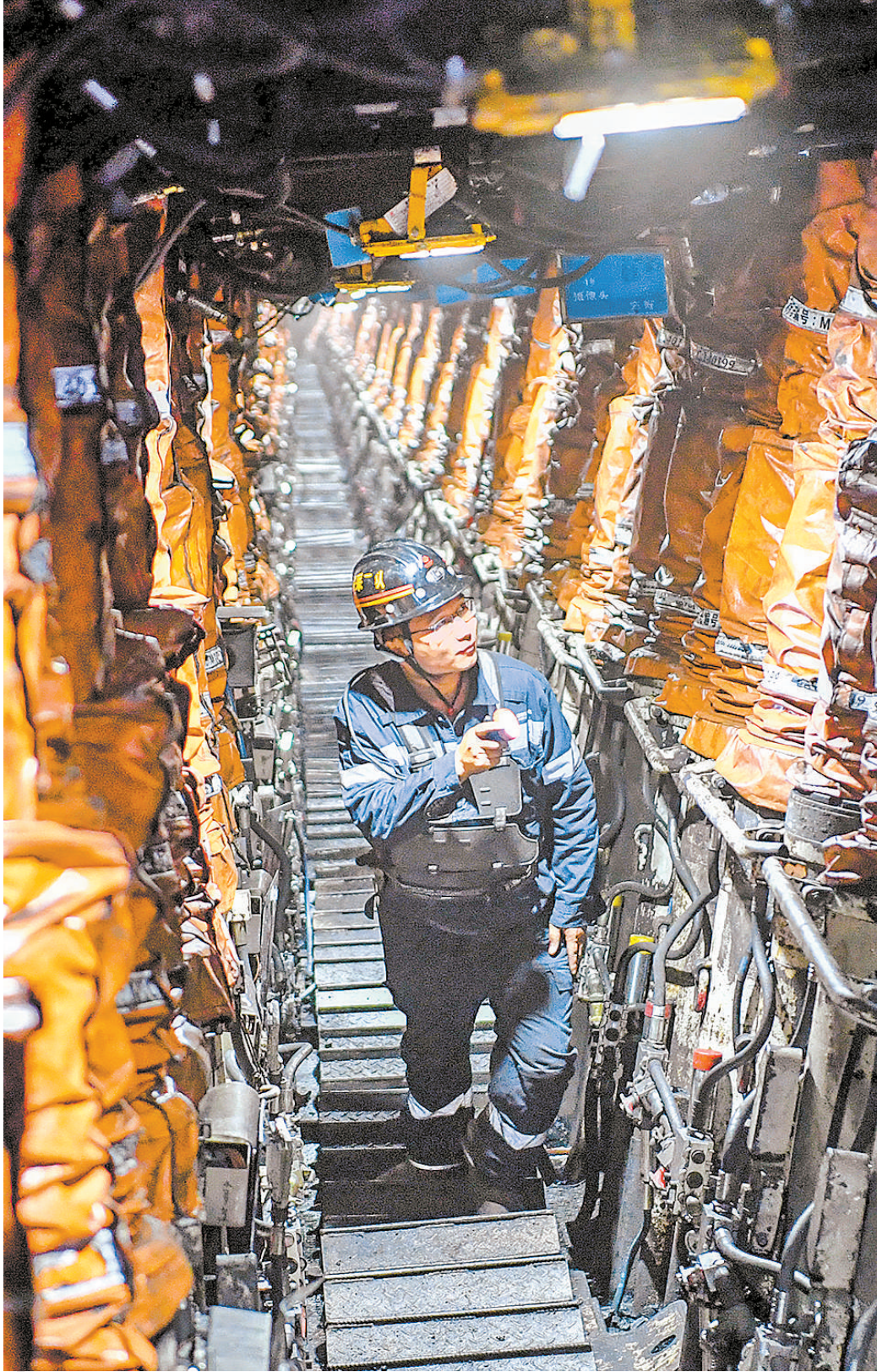
枣泉煤矿150201工作面,直径半米的液压支架一字排开,构成了一个地下钢铁世界。
