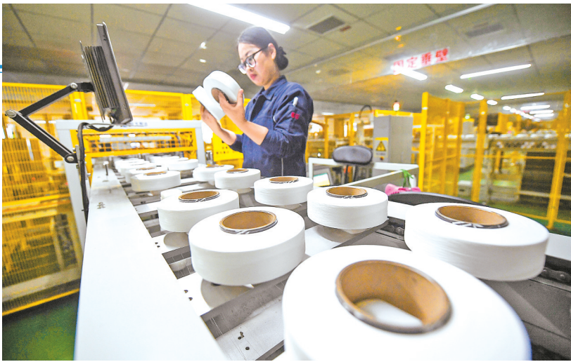
在泰和新材宁东产业园内,工人在检查刚下载的氨纶丝。
