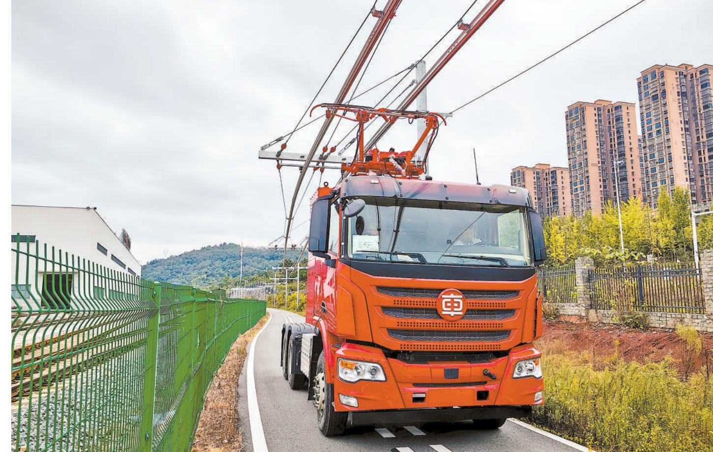
10月21日,一辆电气化公路重卡在中车株机公司电气化公路试验线试验运行。11月7日,在湖南省株洲市召开的2025年中国国际轨道交通和装备制造博览会上,随着一辆体型硕大、头顶有“辫子”(受电弓)的重型卡车亮相,中车株机运用动态补能等技术研发的“智道”电气化公路及露天矿电气化运输系统正式发布。“辫子重卡”运行使用清洁电力,车辆受电弓在线取电,续航不受电池容量限制,此外还拥有风力发电和光伏发电“绿电直连”、多台重卡“串联列队”行驶、智能驾驶等“黑科技”,适合在风力发电、光伏发电富集地区用于公路、矿山重载货物运输,对促进物流绿色转型发展具有积极意义。
