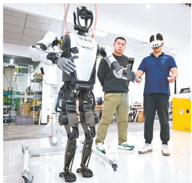
10月24日,张鸿伟(右)在同事的指导下使用VR设备操作机器人遥操作,用于动作捕获采集数据。2022年人社部公示,机器人工程技术人员成为一项新职业。经过3年的发展,机器人的形态、技术不断迭代升级,行业内涌现出更多、更细分的新职业。
