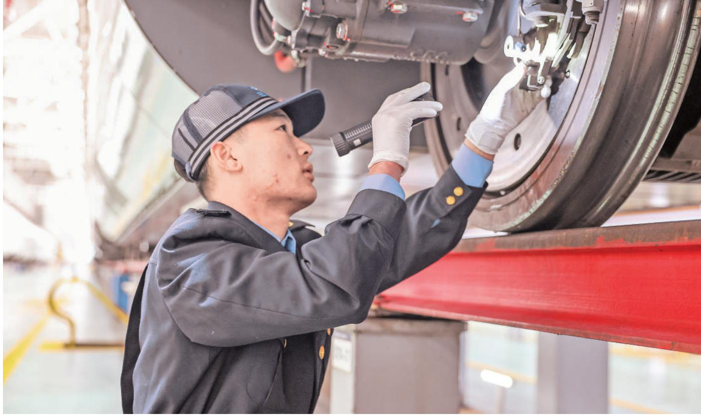
检修人员对走行部螺栓、轮对踏面等关键部位进行细密排查。
