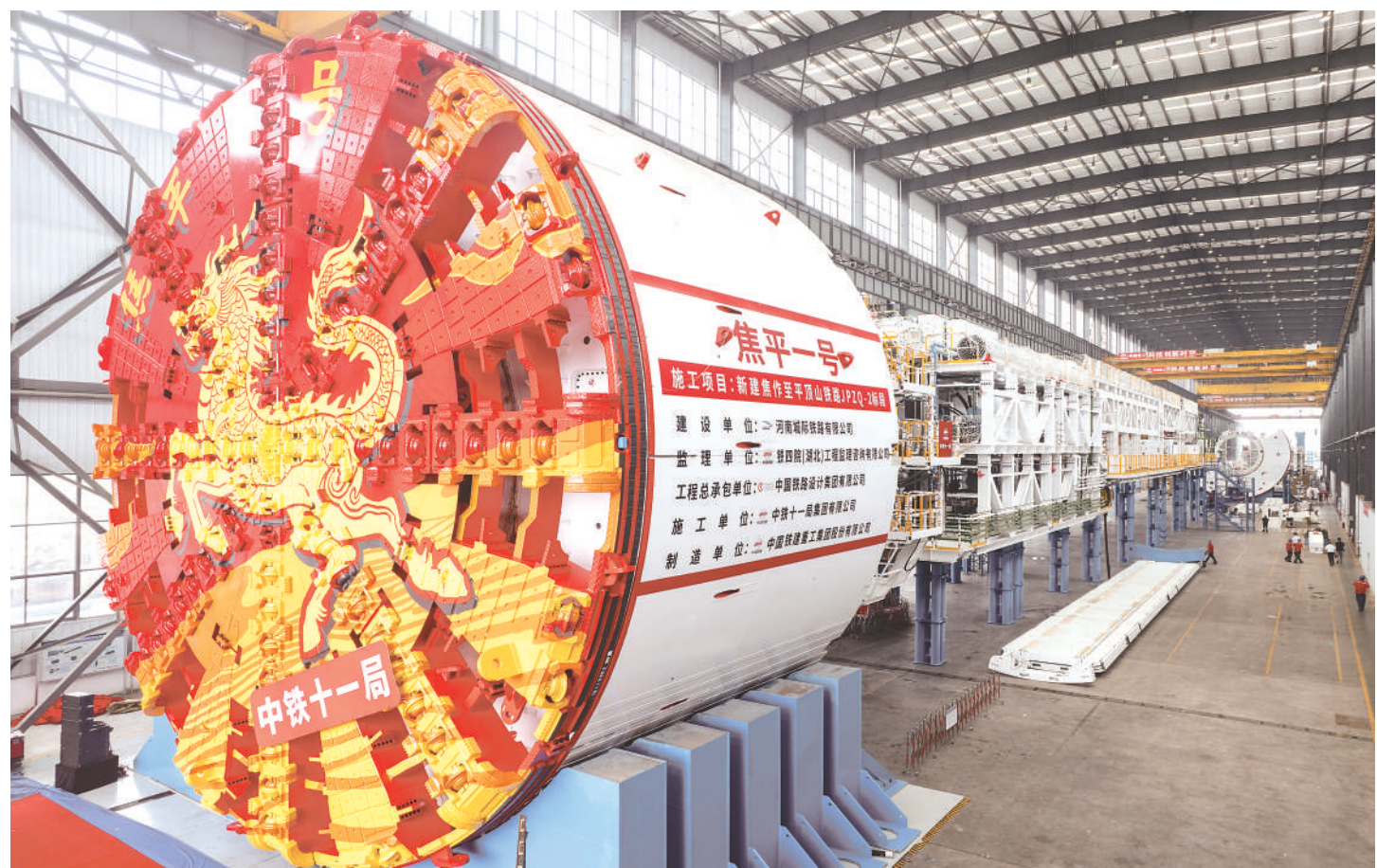
国产超大直径盾构机“焦平一号”下线
