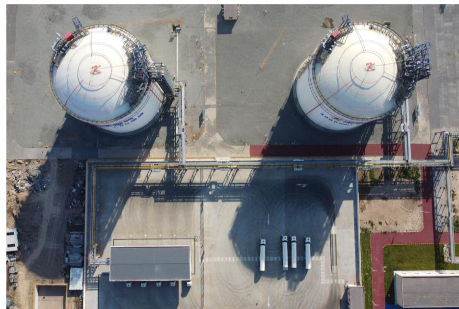
10月18日，俯瞰银川市应急调峰储气库，液化天然气储罐已经建成运行。据悉，该储气库建有两台4万立方米储气罐，在最大储量的情况下，能够提供银川市各类用户约6天的用气量，能够保证银川市民30天以上的生活用气。
