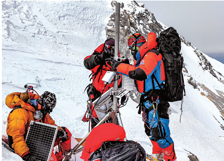
5月23日，科考登顶队员在珠峰海拔约8830米处维护升级自动气象站。 新华社发
