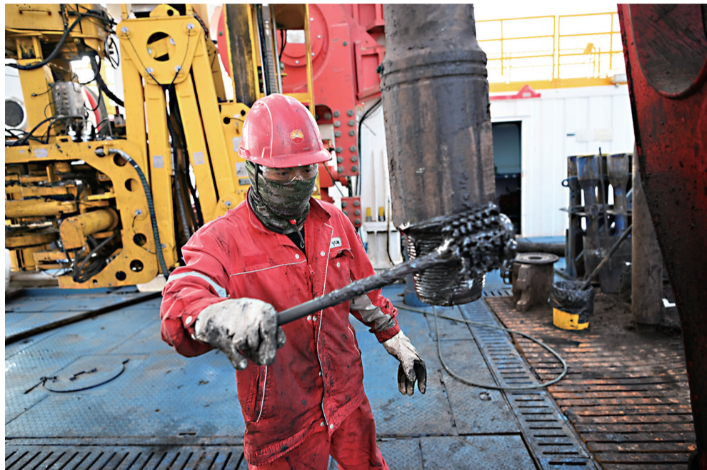
工作人员在“深地塔科1井”钻井平台为钻头涂抹润滑油(2月2日摄)。 新华社发
